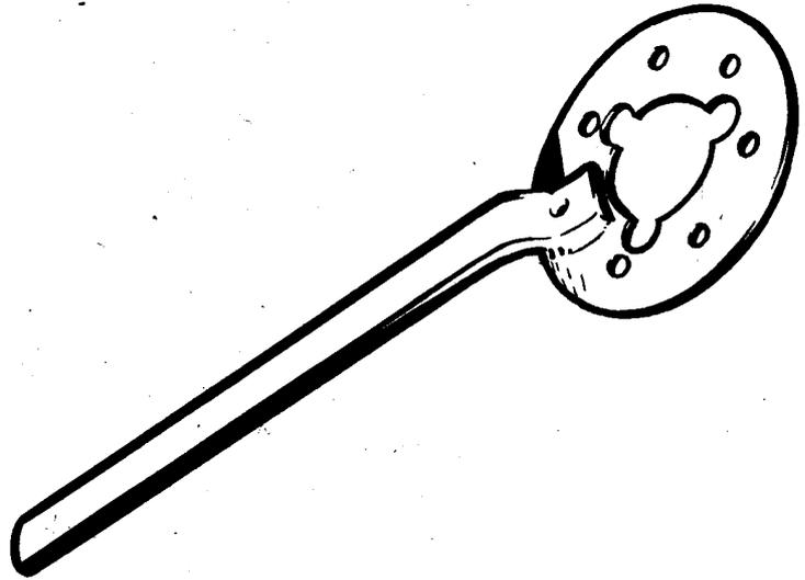
**Montagedorn für Kolbenbolzen**
