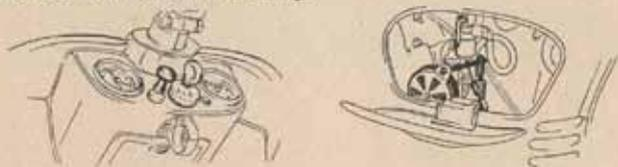
Das Tupfen auf den Vergaserschwimmer wie Öffnen und Schließen der Starterklappe erfolgt durch einen Betätigungsknopf am Armaturenbrett über einen Seilzug auf ein Gestänge.
